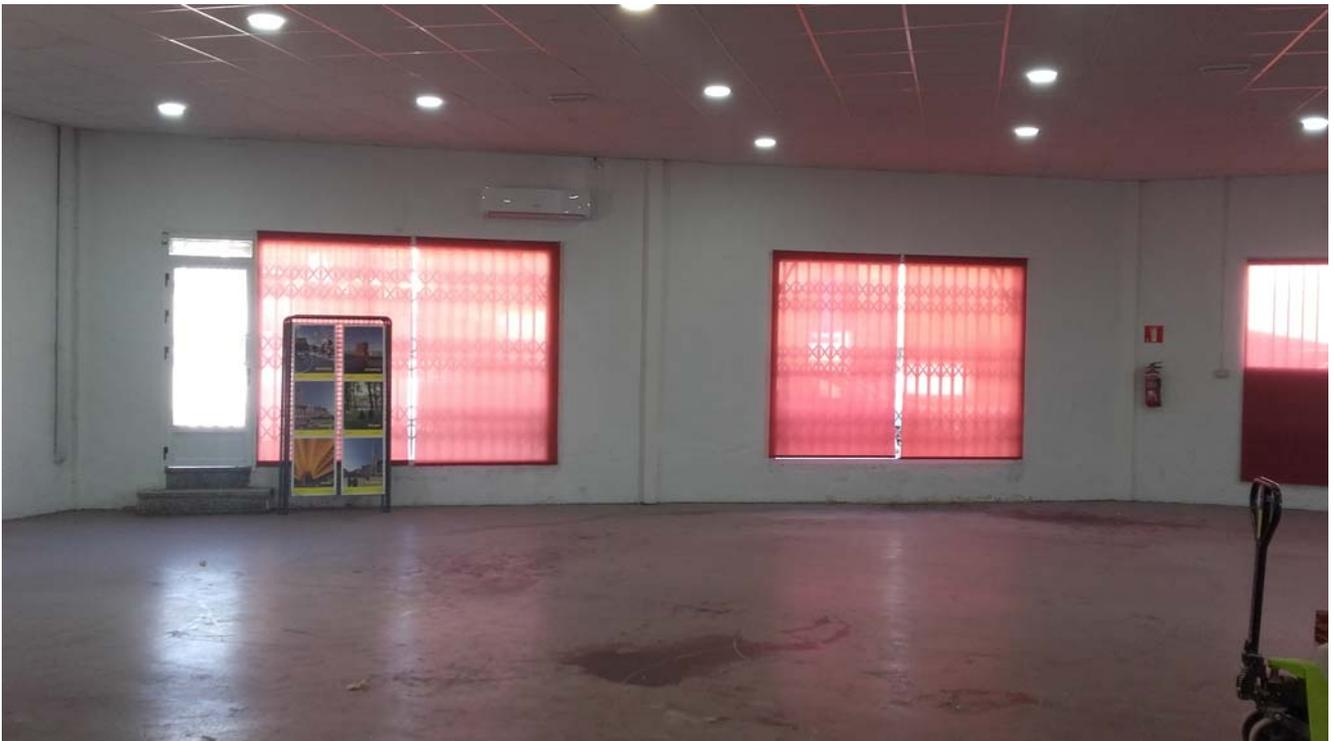
La cubierta del edificio es metálica con chapa de acero sobre correas de acero disponiéndose un falso techo de placas de escayola desmontable con aislamiento de lana mineral. El solado es de hormigón fratasado con tratamiento de superficie en base a resinas. El edificio dispone de aseos accesibles, cocina y barra que dan servicio a un gran espacio diáfano.
