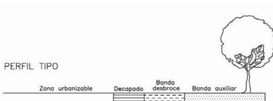
El decapado se sitúa en el perímetro de la infraestructura a proteger. A continuación de la banda de decapado se sitúa una banda de desbroce y, por último una banda auxiliar, tal como se puede observar en la imagen anterior.
