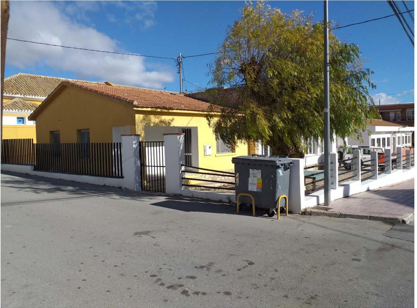
Se trata de una edificación de una planta, con una superficie construida de 80,42 m<sup>2</sup>, realizada con materiales y sistemas constructivos de la época (años 60-70), estructura de muros de carga perimetrales, con ventanas de madera con vidrio sencillo a fachadas dejando en su interior una distribución de estancias con uso salas multiusos, despacho, office y aseo.
