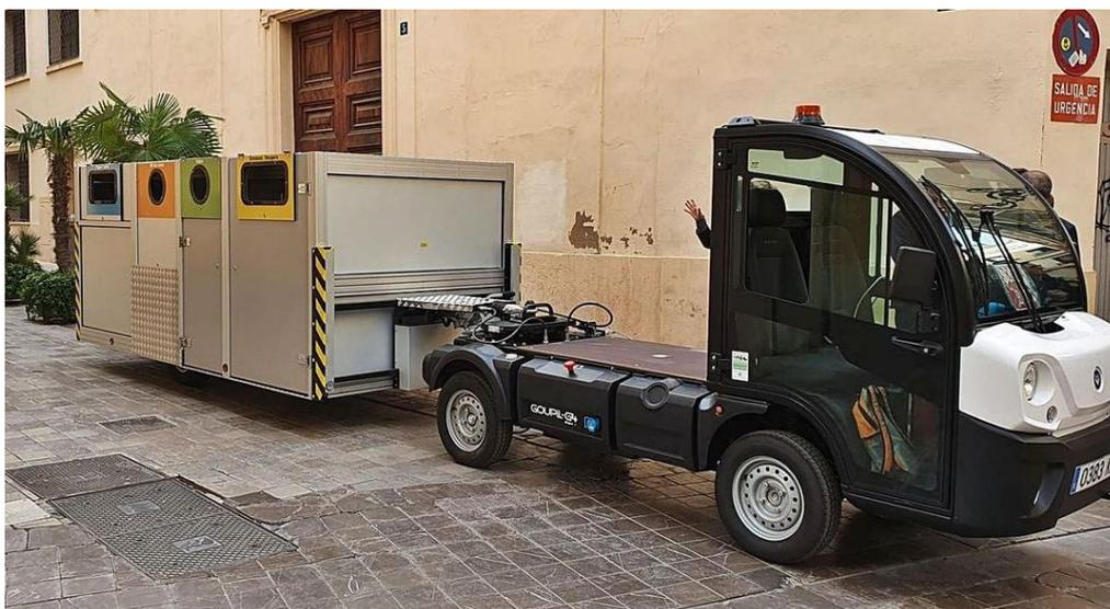
Cuando finaliza el horario de depósito, los remolques son retirados de la calle y transportados hasta el lugar de almacenamiento previsto, en el que son descargados de los
