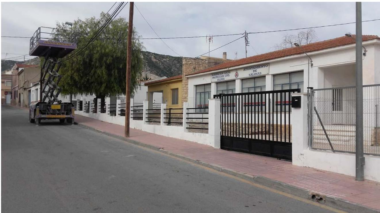
Se trata de una edificación de una planta, con una superficie construida de 100,86 m<sup>2</sup>, realizada con materiales y sistemas constructivos de la época (años 60-70), estructura de muros de carga perimetrales, con grandes ventanales a fachada sur dejando en su interior una distribución de estancias con uso salas de reunión, despachos y aseo.
